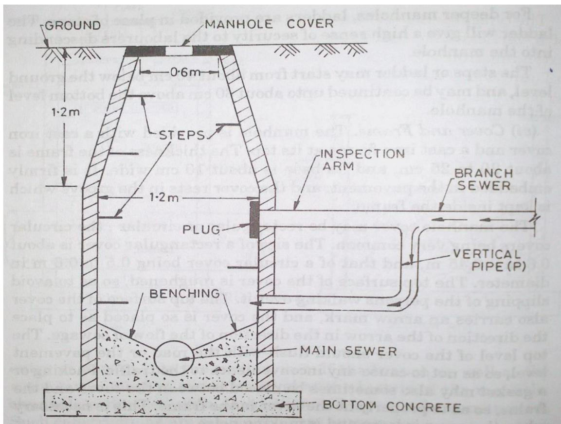
**Fig. Drop manhole**
